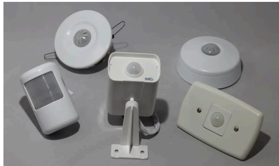
Figura 2: Sensores de presença.
